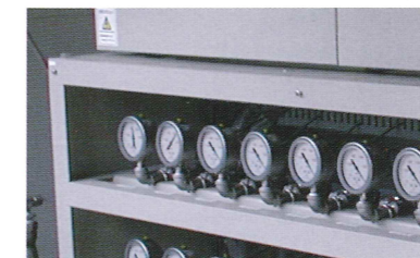
漏水の有無を検知するための真空圧力計
